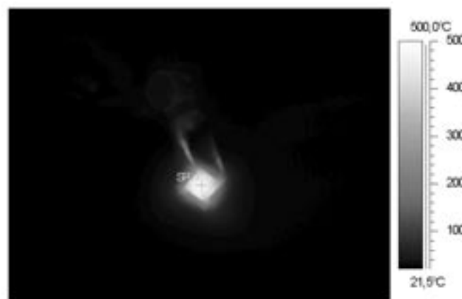
Fig. 6- Imagen obtenida mediante una cámara infrarroja en la que se muestra el comportamiento del microcalentador para una potencia de 1.1\text{W} .
